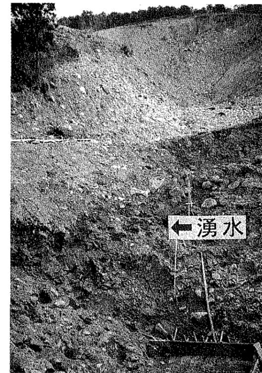
写真2 崩壊斜面付近からの湧水
