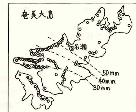
図 1. 被災箇所の分布状況と 17 号台風による最大時間雨量の分布状況
