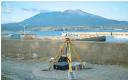
水準測量で使用する道具です。
